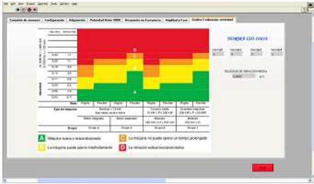
Figura 12. Niveles tolerables e intolerables para análisis de severidad de vibración.
