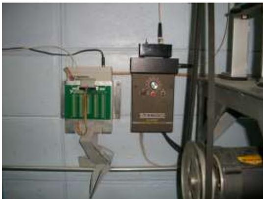
Figura 4. Tarjeta de adquisición de datos DaqPAD-6020E, motor, controlador de velocidad de motor y fuentes de los transductores de aceleración y velocidad.
