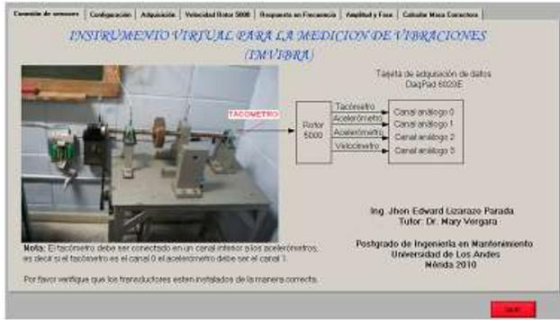
Figura 6. INVIBRA interfaz para medición de vibraciones.
