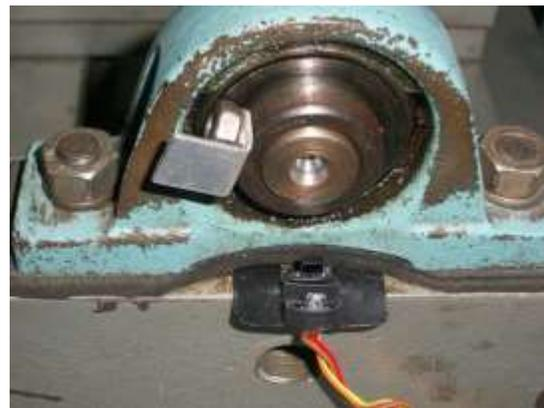
Figura 2. Montaje de emisor y receptor infrarrojo.
