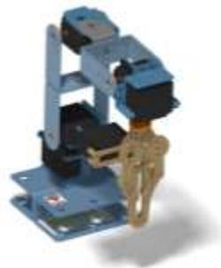
Figura 10. Ensamble y animación del manipulador de 5GDL.
