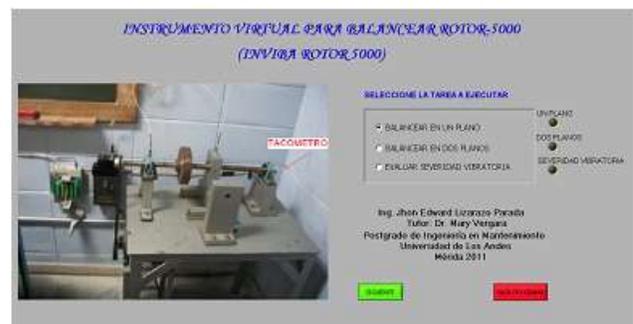
Figura 5. INVIBA interfaz inicial del programa para balancear el ROTOR 5000.
