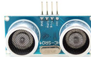
Ilustración 1. Sensor ultrasónico. Fuente: electronilab
