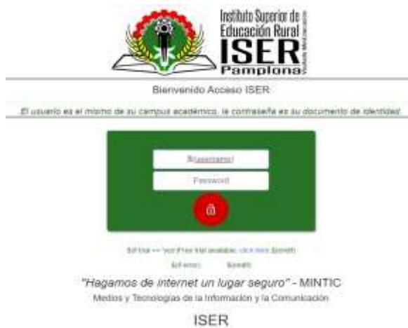
A través del hotspot se realiza logueo de usuarios e igualmente para poder evitar infiltración de usuarios no deseados permitir hasta máximo dos equipos por usuario para loguearse (Ver la Figura 6).
